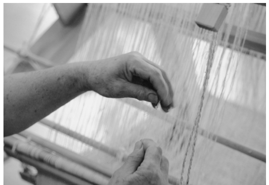
写真14 機結びで切れた経糸を繋ぐ
