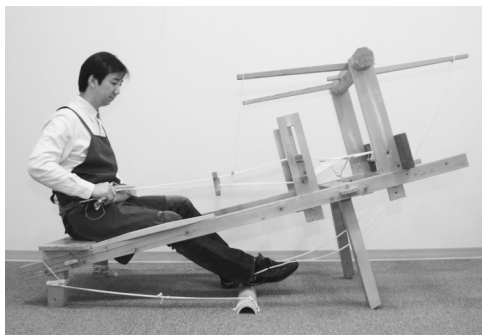
写真17 上糸と下糸を入替えない状態で糸を張る
