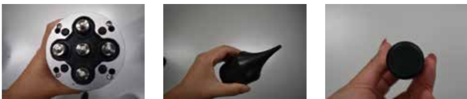
図4-18 トランジューサの種類 (3)S波 40kHz (2)P波 54kHz(指数) (1)P波 250kHz
