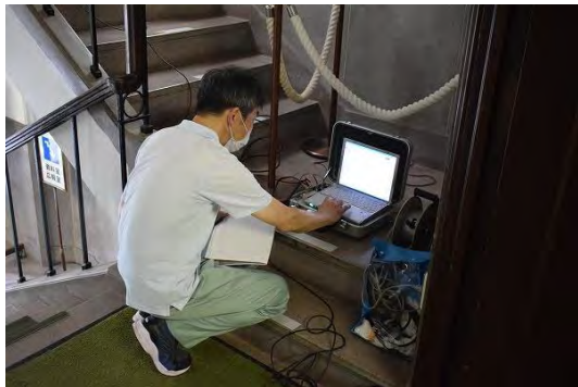
図9 礼拝堂の振動特性調査の様子
